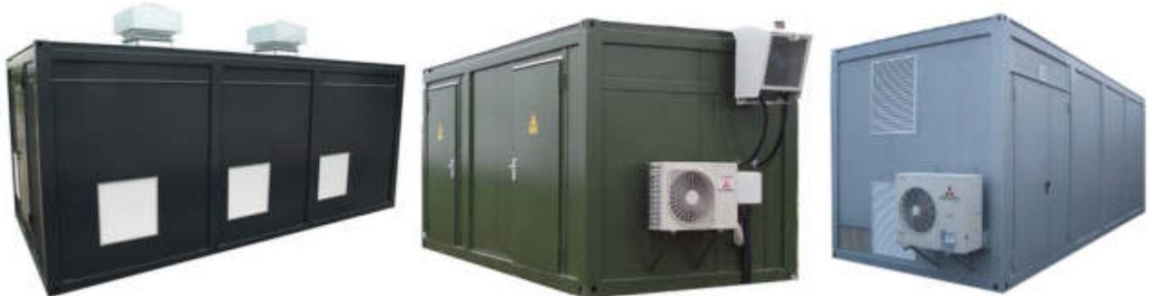
Wir können Ihnen eine Ausführung anbieten, bei der die Container eine abnehmbare Haube haben. Das bedeutet, dass die Komponenten auf der offenen Plattform montiert werden und die Haube dann darüber gestülpt wird. Diese Ausführung erlaubt auch einen unkomplizierten Tausch von schweren Komponenten mittels Kran direkt am Einsatzort.
